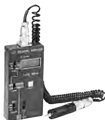
Прибор для контроля сверхмалых подшипников NB-4 (Устройство для определения дефектов) (кат. E410)
